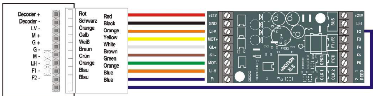
Illustration n°7 : Utilisation du câble DCC avec une locomotive LGB® dotée d'une interface DCC
